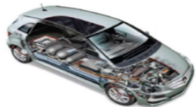
Abbildung 3.25: Schnitt durch die B-Klasse F-Cell [Daimler]
