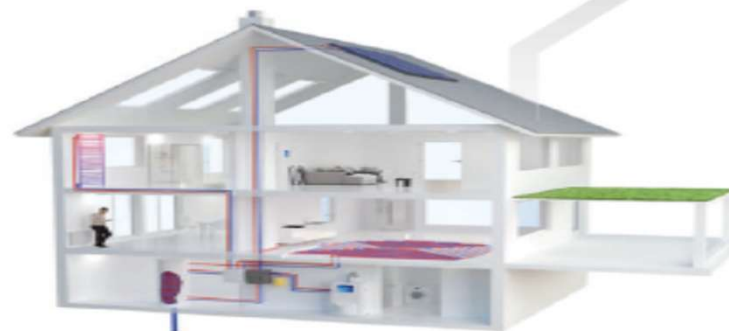
Sanierungsvariante Gas-/Öl-Brennwerttechnik mit Solarthermie
