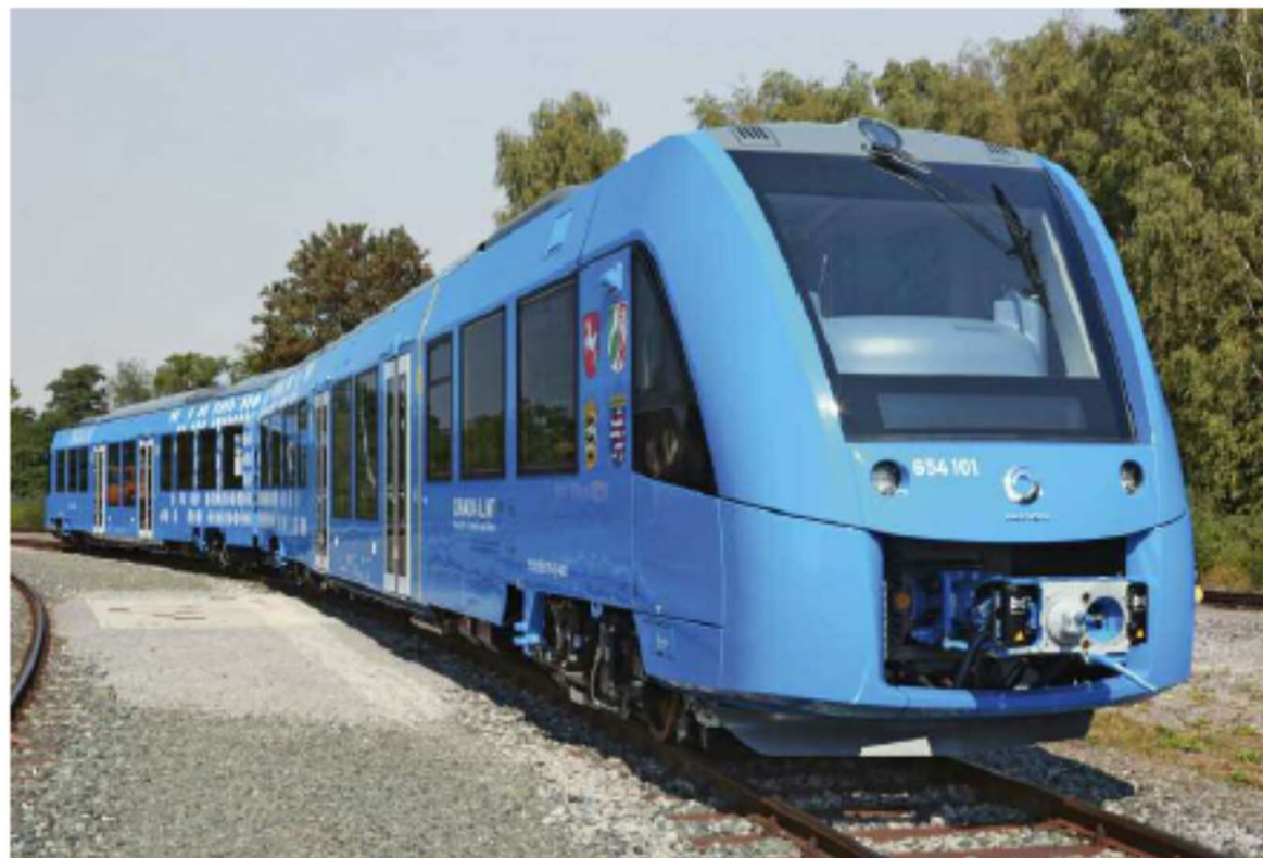
Coradia iLint, Brennstoffzellen-Triebwagen [Alstom/Michael Wittwer]
