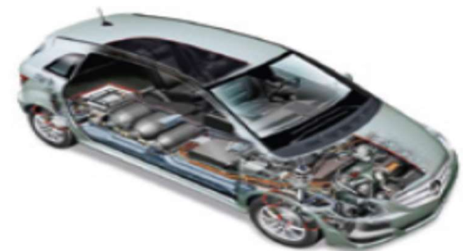
Abbildung 3.25: Schnitt durch die B-Klasse F-Cell [Daimler]
