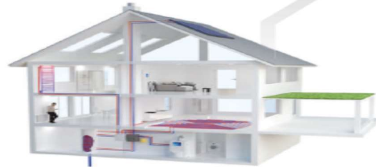
Sanierungsvariante Gas-/Öl-Brennwerttechnik mit Solarthermie
