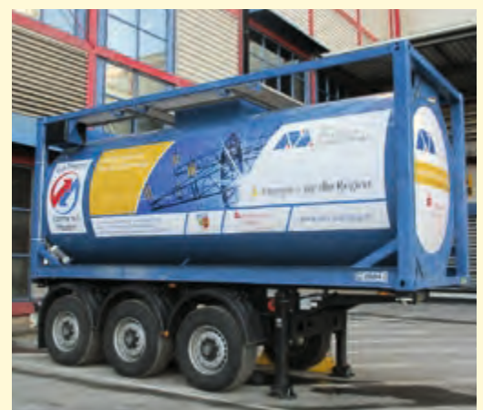
ABB. 43: LATENTWÄRMESPEICHER FÜR DEN MOBILLEN WÄRMETRANSPORT (AVA AUGSBURG 2015)
